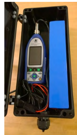
Vue de l'intérieur du coffret
